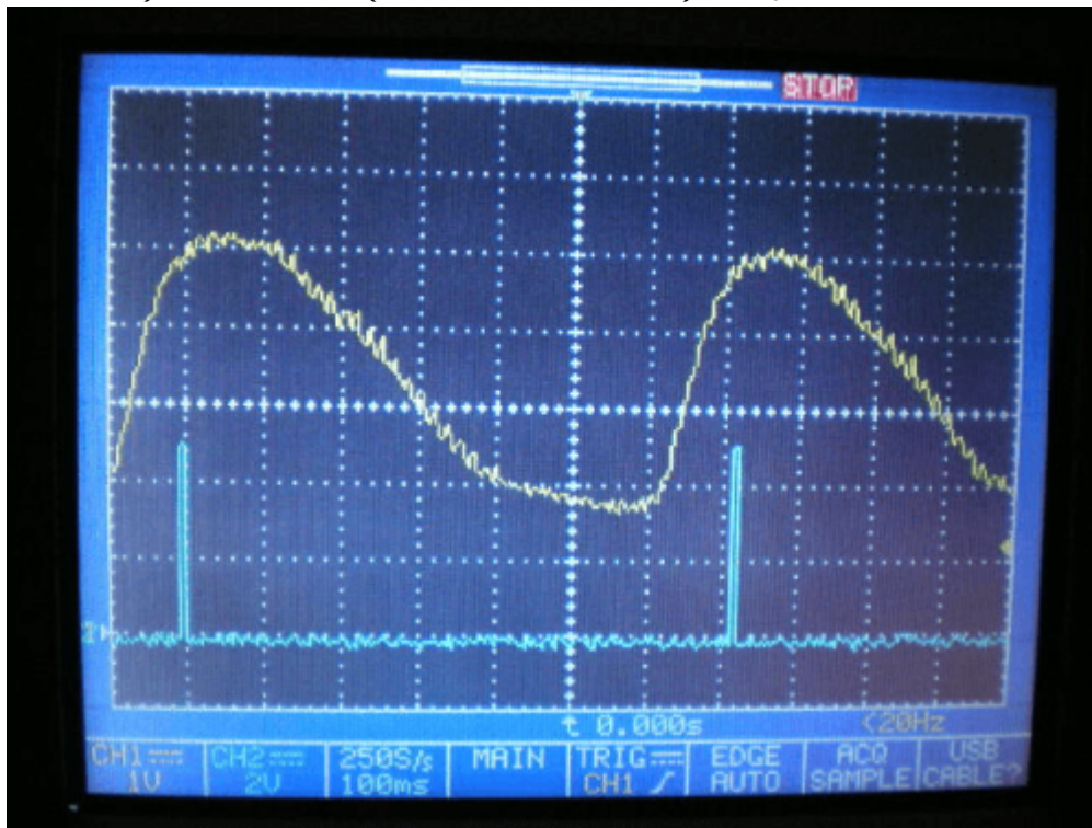
ドレインの波形（つまり心拍の波形）とLEDの波形（つまり検知した波形）です。
