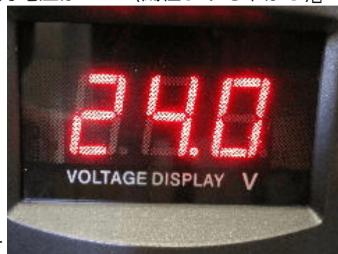
左側上下:閾値を24.0Vに設定する□LEDは点灯 中央上下:入力電圧が23.9V(閾値よりも下がる)□LEDは点灯
