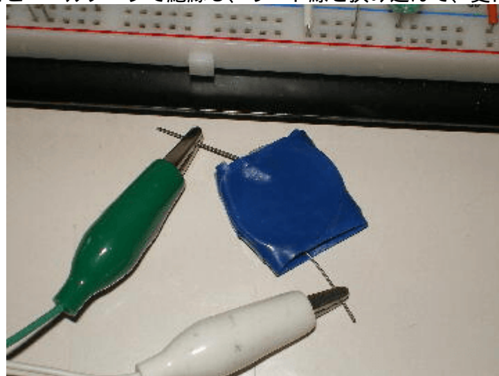
1円玉を2個使ったセンサーです。2個の1円玉の間をビニールテープで絶縁し、リード線を挟み込んで、更に、全体をビニールテ
