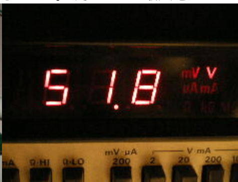
手持ちの電源トランスで動作させて見ました。約49kHzで最大電圧52Vを取り出すことができます。
