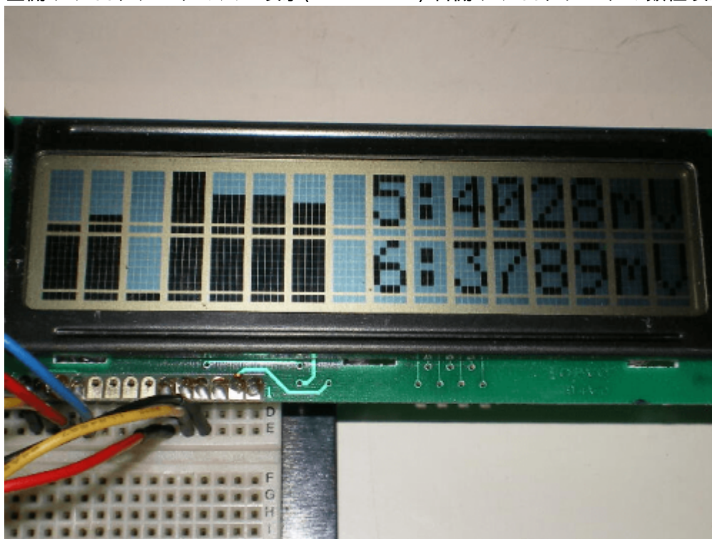
左側:アナログデータのバー表示(CH-1~CH-7) 右側:アナログデータの数値表示(CH-5とCH-6)
