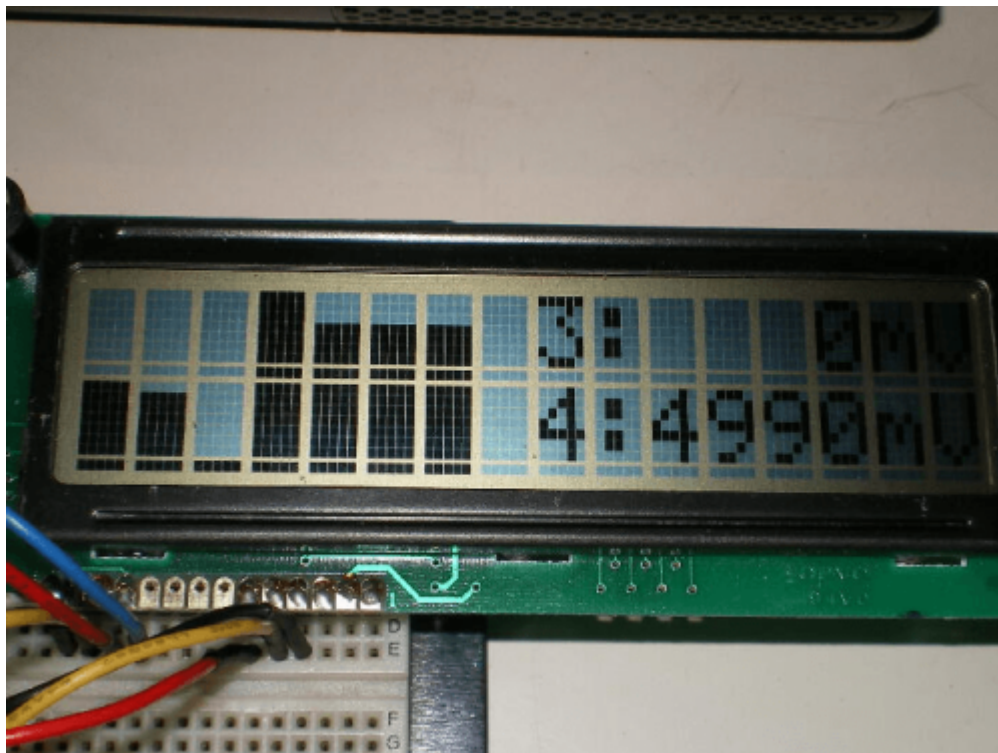
左側:アナログデータのバー表示(CH-1~CH-7) 右側:アナログデータの数値表示(CH-5とCH-6)
