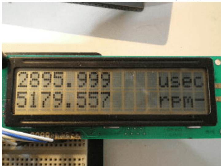
左側:モーターを3Vで廻した時のパルス幅と回転数です。 右側:モーターを4Vで廻した時のパルス幅と回
