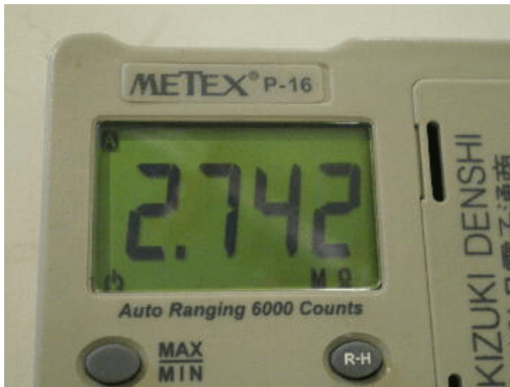
3.3MΩの測定結果です。(右側は、手持ちのテスターの測定結果です)
