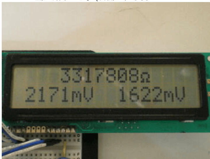
3.3MΩの測定結果です。(右側は、手持ちのテスターの測定結果です)
