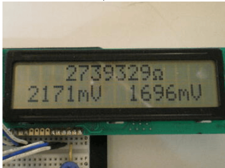
2.7MΩの測定結果です。(右側は、手持ちのテスターの測定結果です)
