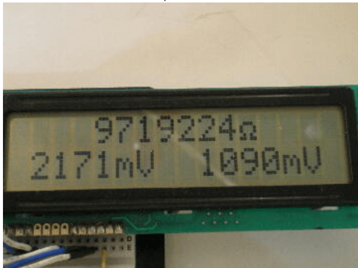
9.1MΩの測定結果です。(右側は、手持ちのテスターの測定結果です)
