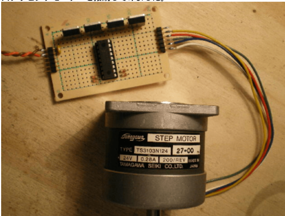
ステッピングモーターの電源は、PICに供給している+5Vをそのまま使用しました。赤色のミノムシクリップがステッピングモーターの電源です。本来は、ここに+12Vを加えます。
