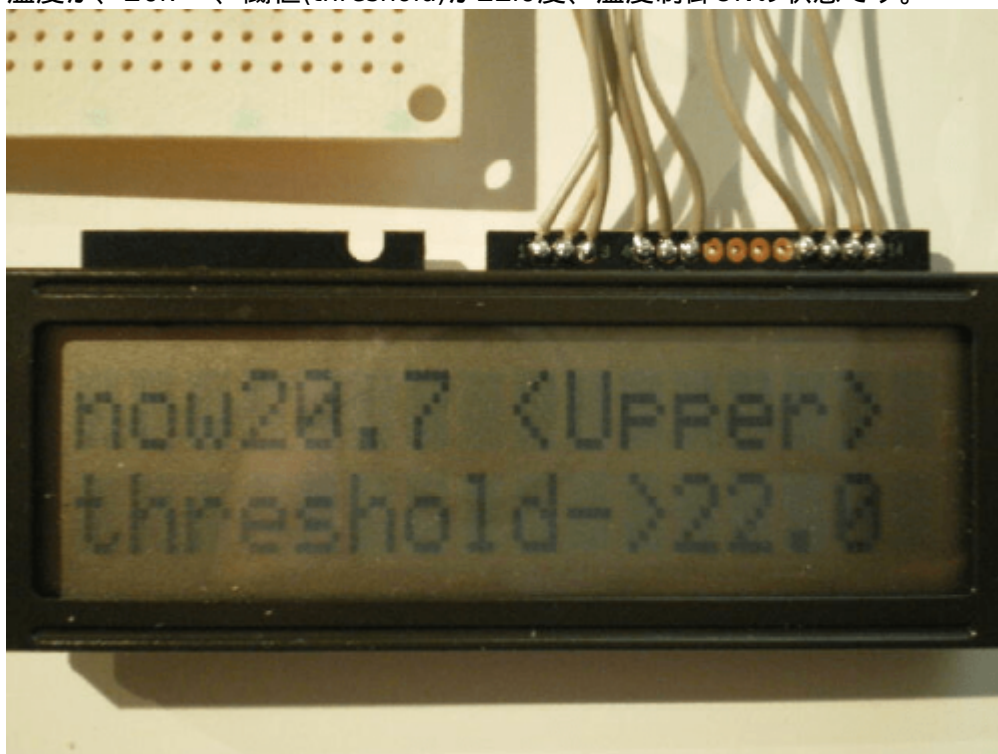
温度制御画面です。現在温度が、20.7、閾値(threshold)が22.0度、温度制御ONの状態です。
