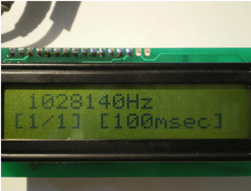
<FC_TYPE_A>プリスケーラ(1/8)、ゲートタイム(0.1秒) 精度80Hz
