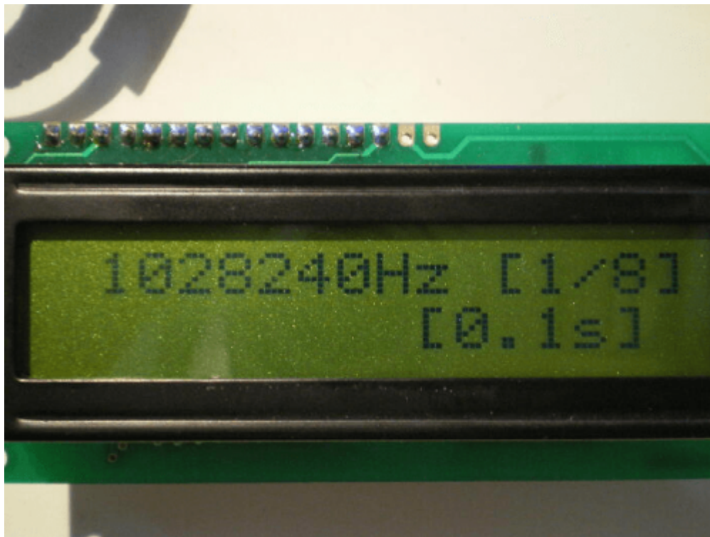
<FC_TYPE_B>プリスケラ(1/8)、ゲートタイム(0.1秒)kHz表示 精度80Hz
