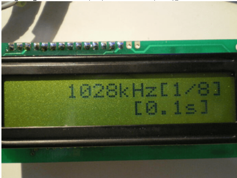
<FC_TYPE_B>プリスケラ(1/8)、ゲートタイム(0.1秒)kHz表示 精度80Hz
