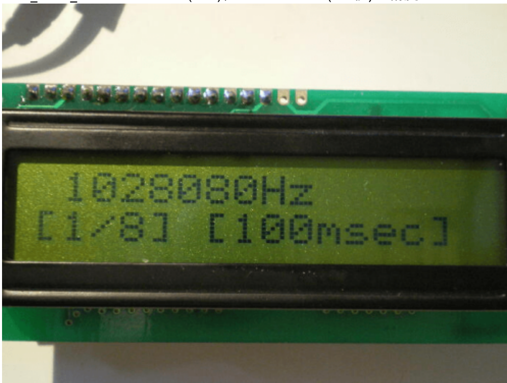
<FC_TYPE_B>プリスケーラ(1/8)、ゲートタイム(0.1秒)□-455kHz□Hz表示 精度80Hz
