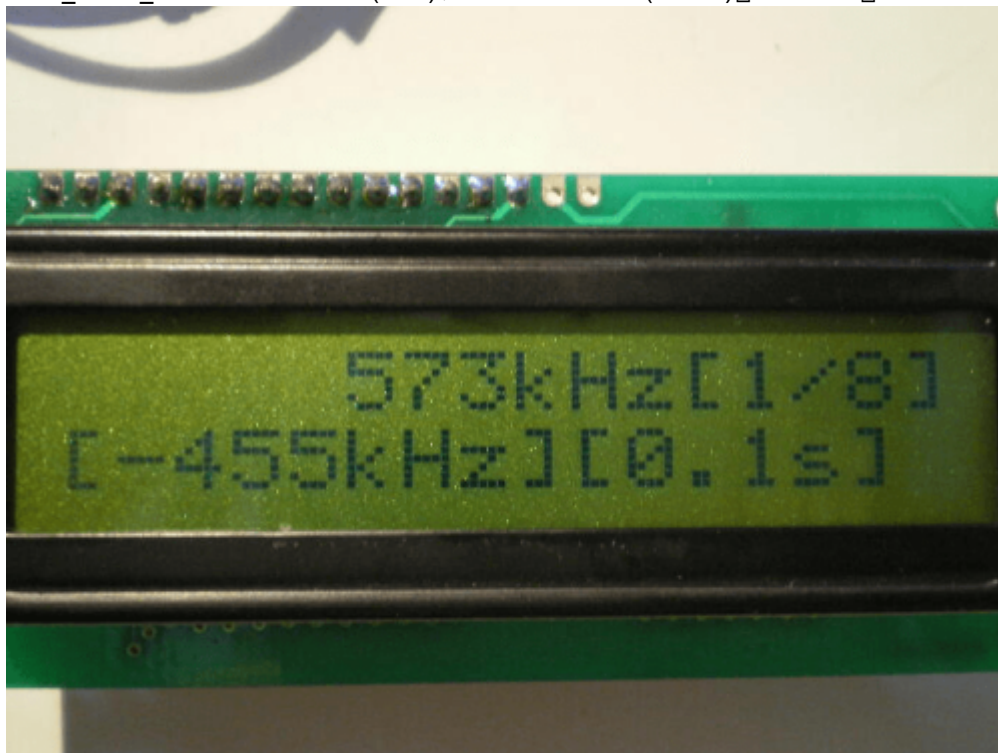
<FC_TYPE_B>プリスケーラ(1/8)、ゲートタイム(0.1秒)□Hz表示 精度80Hz
