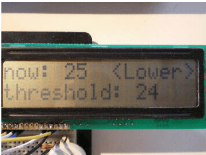
<下限値制御> 左上:現在温度が25 、閾値が24 なので、出力はOFFになります。 左下:出力OFF 赤色LEDは消灯 右上:現在温度が25 、閾値が25 なので、出力はONになります。 右下:出力ON 赤色LED
